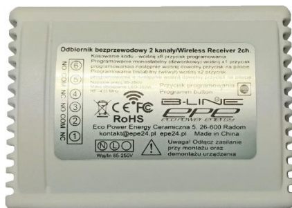
Rys. 4 Widok odbiornika układu zdalnego włączania/wyłączania
