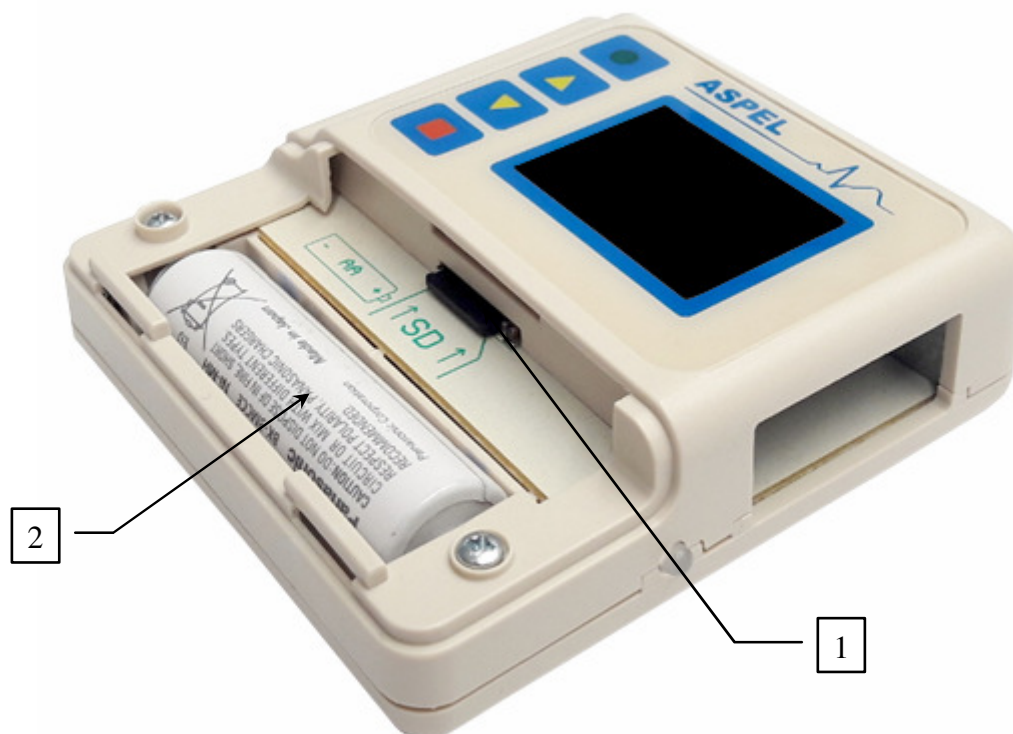
Rys. 3. Rejestrator AsPEKT 703/712 v.3xx – widok gniazda karty i baterii
