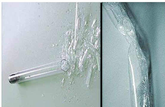
Rys. 2 Stłuczony promiennik - bez folii antyrozryzgowej (po lewej) i z folią (po prawej)
